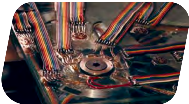
Badanie określające naprężenia wokół otworu
