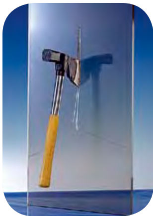
Badanie szkła antywłamaniowego z wykorzystaniem siekiery. Klasy: P6B, P7B, P8B
